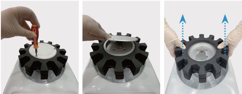
1. 去掉上盖螺丝 2. 去掉上盖 3. 用双手小心地拖着适配器的两侧向上拉。
